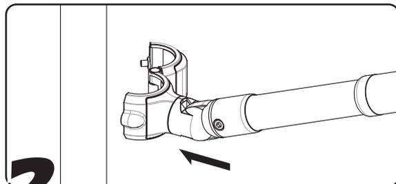
**2** 手すりを伸ばしもう一方のベスポジ本体に連結させます。
