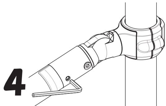
**!** 最後に手すりの伸縮を固定させるため右回りにレンチで「カチッ」と音がするまで、締めてください。
