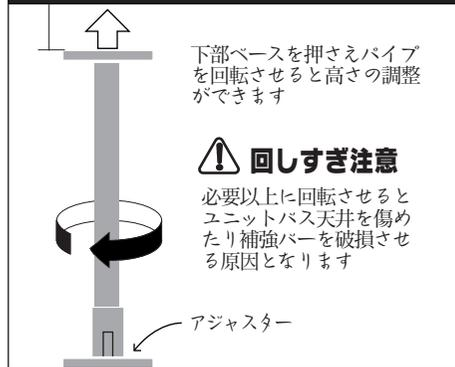
補強バーを設置しパイプを回転させアジャスターを上げ天井高まで伸ばしてください
