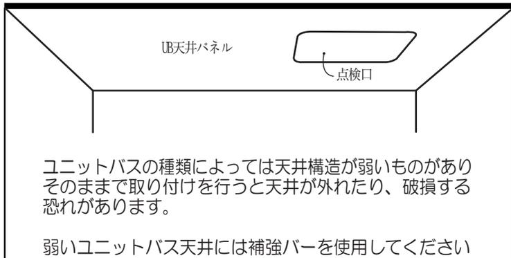
ユニットバスの種類によっては天井構造が弱いものがありそのまま取り付けを行うと天井が外れたり、破損する恐れがあります。
